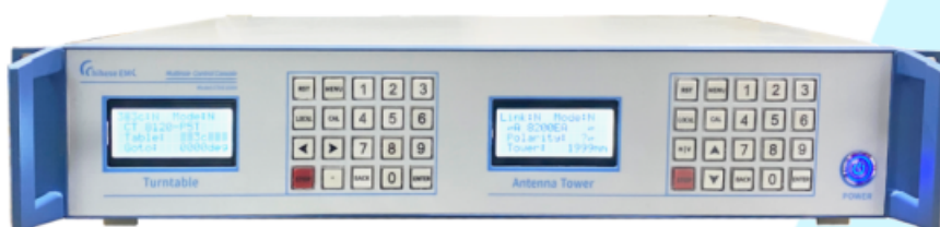
天线塔控制器
